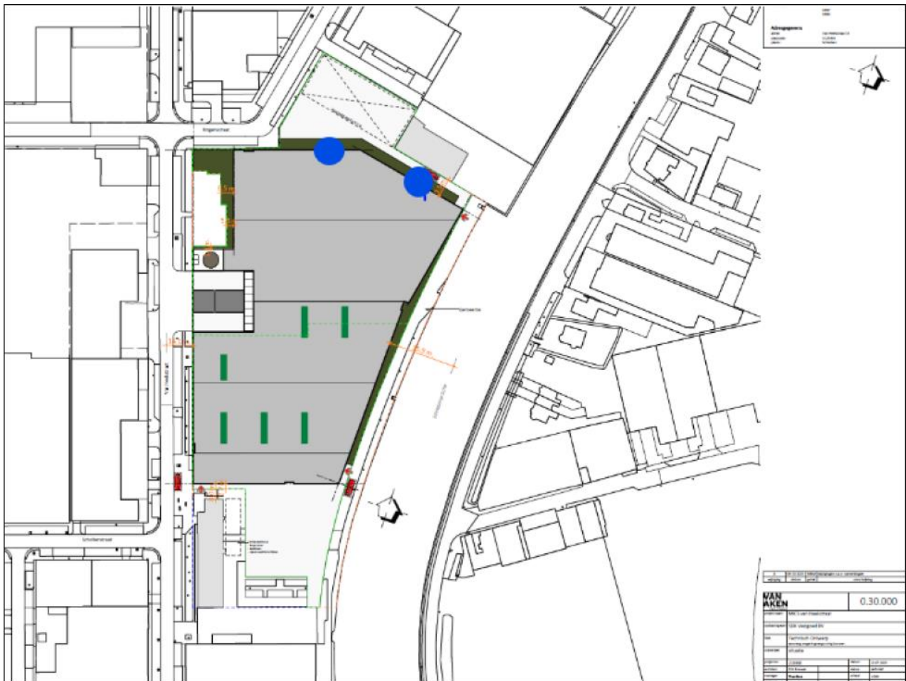
Figuur 1: Plaatsing paalkasten ter permanente compensatie, waarbij de blauwe punten de locaties weergeven.
