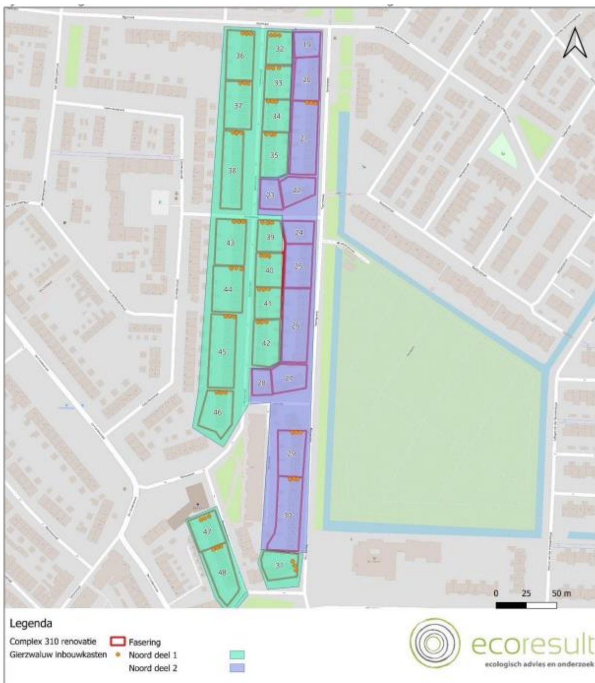
Figuur 7 alternatieve voorzieningen gierzwaluw op alle kopgevels; in totaal 63 IBGZ03 of GZP2 inbouwkasten. Bron: aanvullende informatie.
