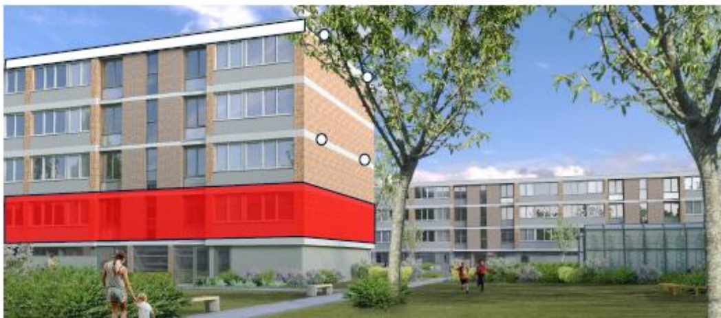
Figuur 15 Globale locaties waar de permanente inbouwviervuiskasten in de gevels worden gesitueerd (zwarte kaders en cirkels). De kasten worden verspreid over de gevels aangebracht en alle inbouwkasten zijn van het type IB VL 06 of vergelijkbaar. Oosthof fase 4 is betreft een vierlaags wooncomplex. Daarom is één woonlaag gemarkeerd als 'niet van toepassing' (rood).
