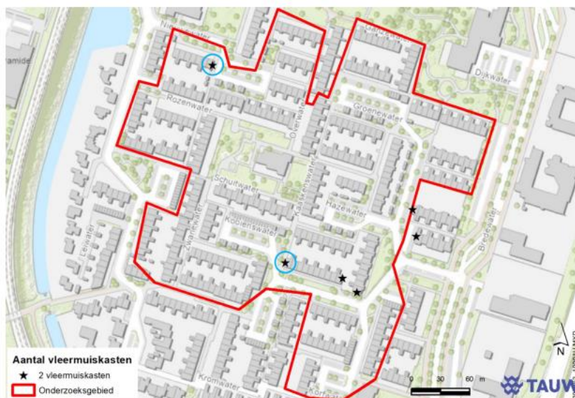
Figuur 4.2 De 12 geplaatste vleermuiskasten. Er zijn 2 kasten per kopgevel geplaatst en er zit minimaal 3 meter tussen de kasten. De 4 kasten die met blauw omcirkeld zijn, gelden ter compensatie voor het paarverblijf waarvoor de vergunning wordt aangevraagd in dit document
