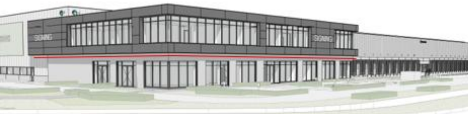
Figuur 3 Rode lijn geeft aan waar de spouw opgehouden wordt ter realisering van de permanente verblijfplaatsen.
