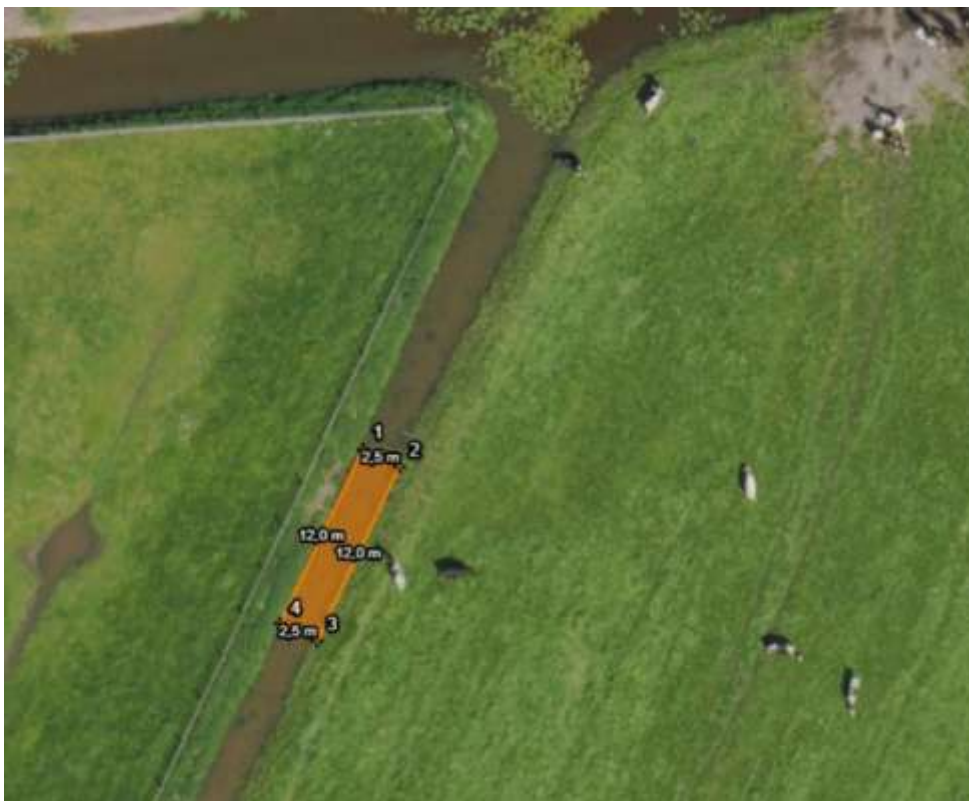
Figuur 3 De locatie van de watergang bij uittredepunt HDD2 (ter hoogte van de Tiendweg, Alblasterdam) van de aan te leggen leiding. De benodigde oppervlakte (oranje vlak luchtfoto) voor de aan te leggen zinkerkuip is circa ca 30,4m2 x1,5m hoogte. Dit geeft circa 46m3 slib.
